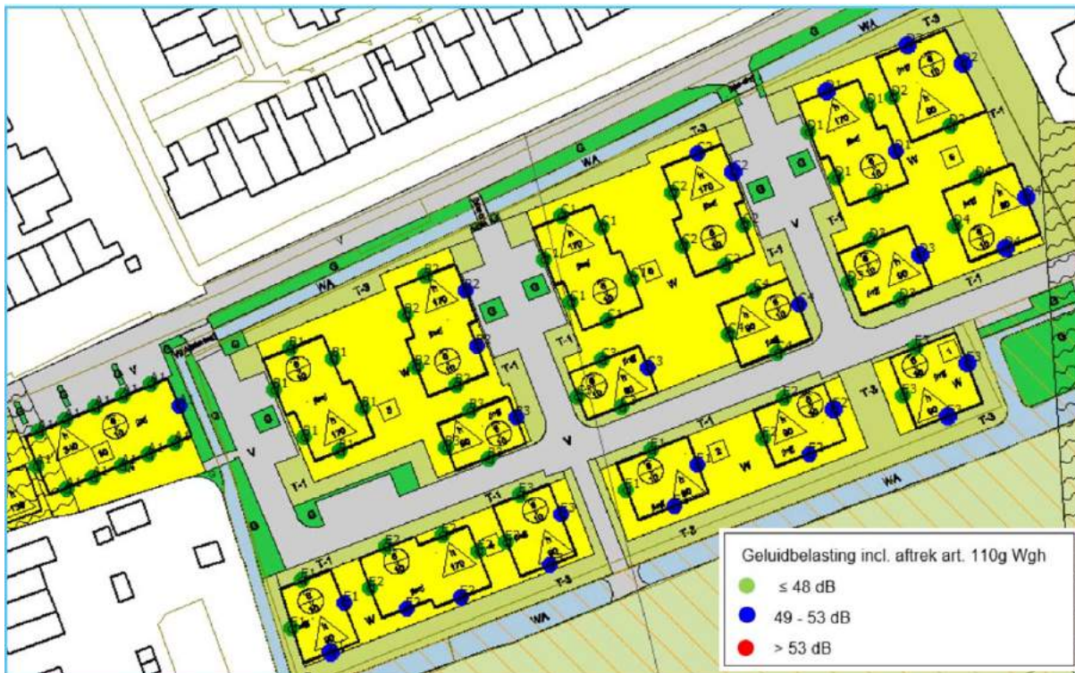
Afbeelding 16: rekenresultaten akoestisch onderzoek, na aftrek artikel 110 Wgh Bron: Rapport akoestisch onderzoek Ontwikkeling Holendrechterweg Ouderkerk aan de Amstel, Aveco de Bondt, p. 6
