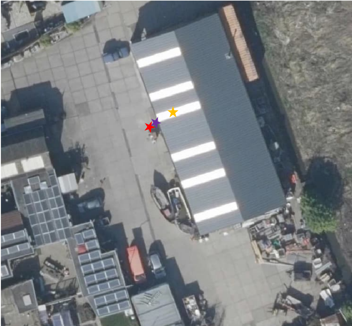
Figuur 3: Ligging geluidbronnen (open deuren: paarse ster, lichtstraat: oranje ster, rijden heftruck: rood gestippeld).
