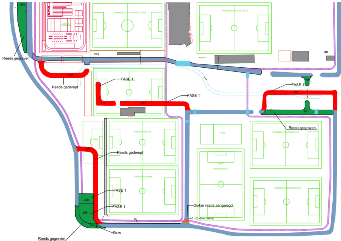
Afbeelding 3: dempen en graven in watersysteem De Toekomst
