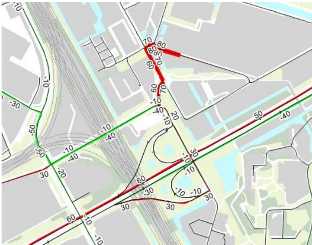
f4.2 Vershil tussen autonome situatie en situatie na realisatie beoogde ontwikkeling (bron: Verkeersonderszoek Wenkebachweg door gemeente Amsterdam uit 2022)
