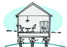
Grondwaterpeil te laag: paalrot
