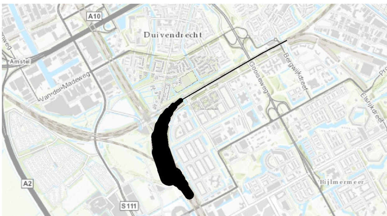
Figuur 16 Gemodelleerde baanvakken (De breedte van de zwarte contour wordt bepaald door de breedte van het baanvak zoals in tabel 7 opgenomen. Ten noordoosten en zuidenwesten van de grenzen van het plangebied is de lengte van het gemodelleerde spoor begrenst op 1 km, dit conform QRA methodiek.
