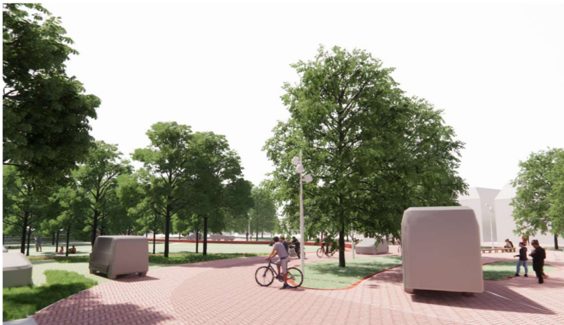
4.1 geen hoogteverschil tussen voetpad en rijweg aanwezig en een geringe kleurscheiding.
