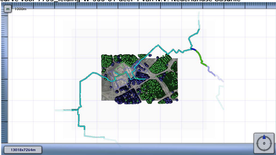
Figuur 4.2 Kilometer leiding behorende bij de maximale overschrijding van de FN-curve voor 7755_leiding-W-533-01-deel-1 van N.V. Nederlandse Gasunie
