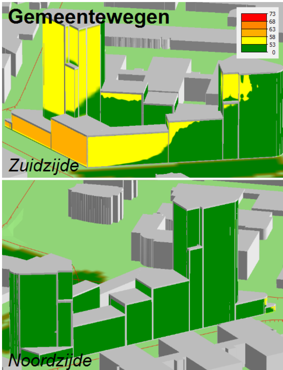
Figuur 4.11: verticale geluidcontouren als gevolg vavn gemeentewegen, inclusief aftrek (bron: Peutz, juni 2022).
