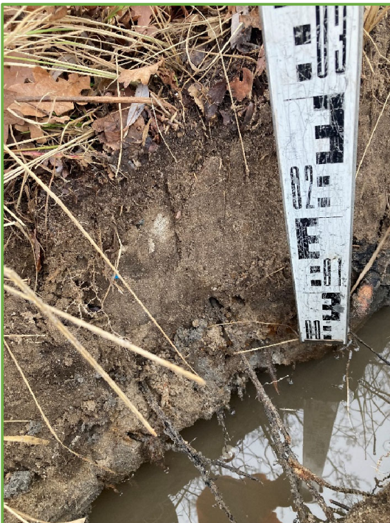
Grondwaterpeil staat hier heel hoog, nabij 40 cm -mv. Bodemopbouw bestaat uit humusarm zand.
