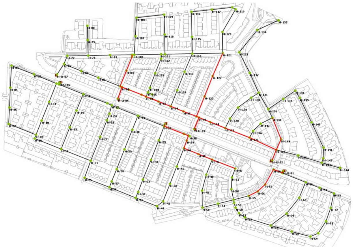
Figuur 3.1: Leidingdiameters: zwart (300 mm) en rood (400 mm)
